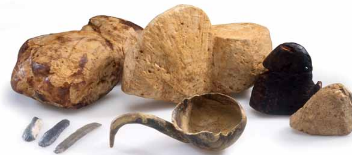
Verschiedene Stadien der Holztassenherstellung. Vorne das Endprodukt.
